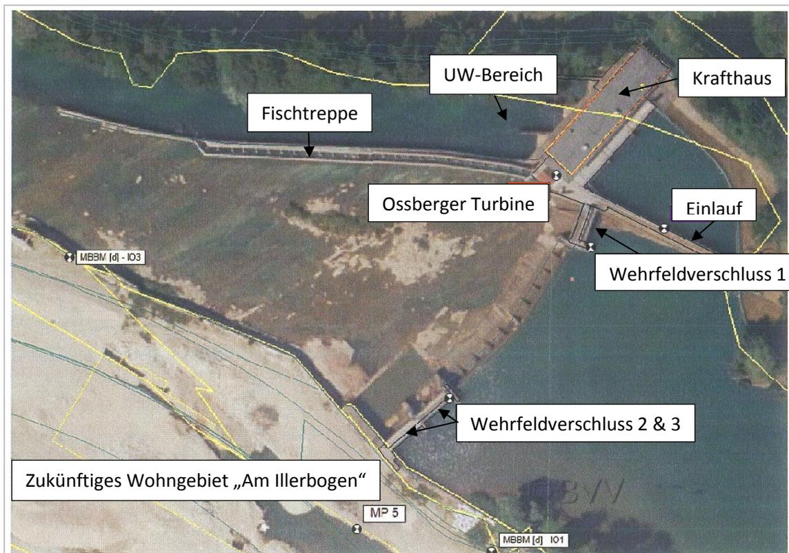
Abbildung 1: Lageplan mit Kraftwerk Hegge, Wehranlage, Fischtreppe und Ossberger Turbinen, sowie zukünftigem Wohngebiet
